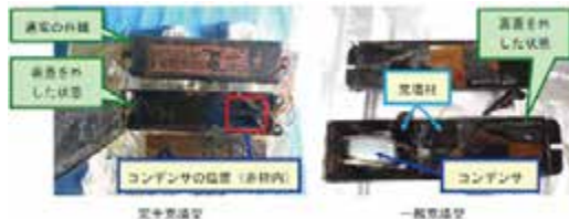
図2 コンデンサ充填材固定型安定器の例(禁止)
