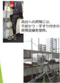
荷台への昇降には、手掛かり・手すり付きの昇降設備を使用。
